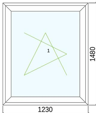
**Konstruktion mit 1 Element, 1230.0 mm x 1480.0 mm**
