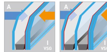
Die innere wärmeisolierend beschichtete Klarglasscheibe wird als Verbundsicherheitsglas ausgeführt. Dabei werden zwei ca. 3 mm starke Klarglasscheiben mit einer hochelastischen Folie aus Polyvinylbutyral (PVB) aneinandergeklebt. Bei Glasbruch haften die Bruchstücke auf der Folie. Somit können sich keine scharfkantigen Glassplitter lösen. Die zähelastische Folie erschwert das Durchdringen durch das Glaselement.
