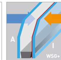
Den Basiswärmeschutz erhalten Sie bei uns bereits ohne Aufpreis. Abhängig zum Glasanteil der gewählten Türfüllung, variiert der rechnerische U-Wert der Füllung ( $U_p$ ) modellbezogen zwischen 0,91 und 1,19\*. Dieser Wert wird durch die Verwendung von speziellem Wärmeschutzglas erzielt. Es besteht aus einer wärmeisolierenden Soft-Coating-Beschichtung auf der inneren Klarglasscheibe (2-fach Isolierglaseinheit) in Verbindung mit einem Warm-Edge-Randverbund.
