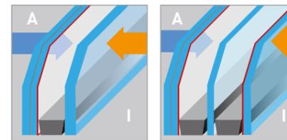
Bei dieser Ausführungsart besteht die äußere wärmeisolierend beschichtete Scheibe aus zwei ca. 4 mm starken aneinandergeklebten Klarglasscheiben mit einem Prüfzeugnis für Durchwurfhemmung.
