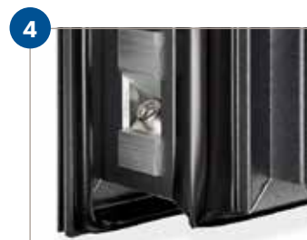
STABILE ECKVERBINDUNGEN Profile auf Gehung verschraubt, ver- klebt und verbolzt
