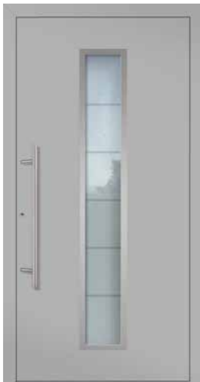
A 16 1) U d -Wert 0,80 1) Farbe: RAL 9006 Weißaluminium FS Verglasung: Mattiert mit klaren Streifen LA 200 x 1.600 mm Rahmen in Edelstahloptik außen Mindestmaß = 800 x 1.990 mm
